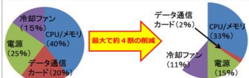
光配線への置き換えによるサーバの消費電力削減効果
