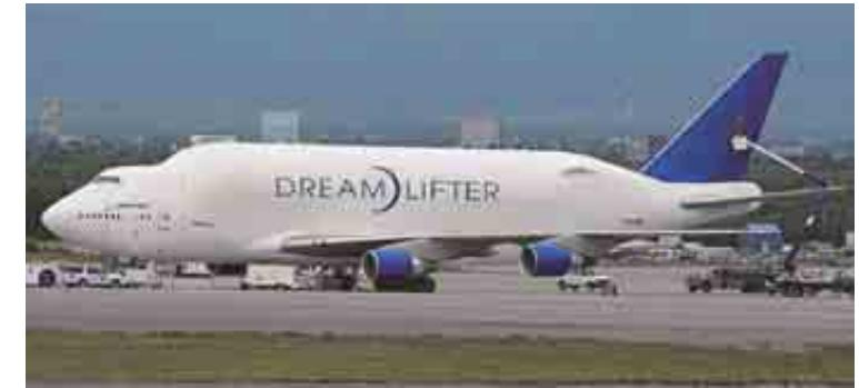
ドリームリフター：飛行機の胴体、翼などの大型部品を運ぶことができる貨物専用便。離陸には2800m以上の滑走路が必要とされる。
